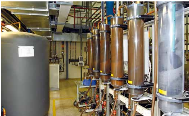
Špeciálne testovacie zariadenia na testy odolnosti čerpadiel v rôznych vykurovacích systémoch
