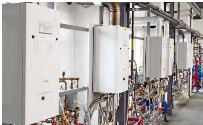
Okrem elektrických kotlov sa v závode vyrábajú aj plynové kotly, predovšetkým nekondenzačné, na obrázku sú priestory na testy životnosti kotlov
