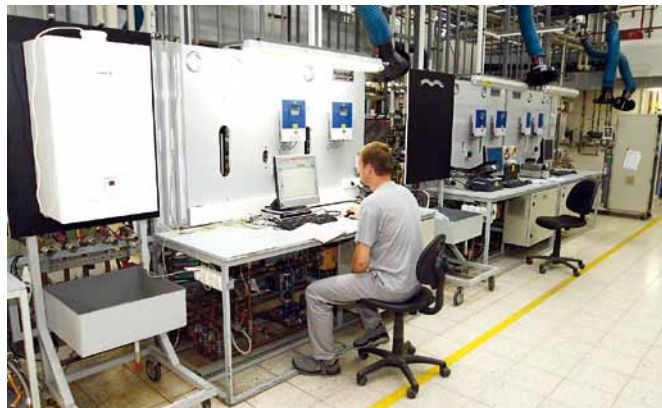
Testovací technik laboratória overuje parametre kotla pri každej zmene súčiastky v hydraulické či spaľovacej časti kotla
