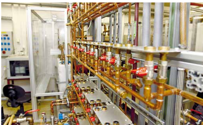
Špeciálne testovacie zariadenie životnosti sekundárnych výmenníkov tepla
