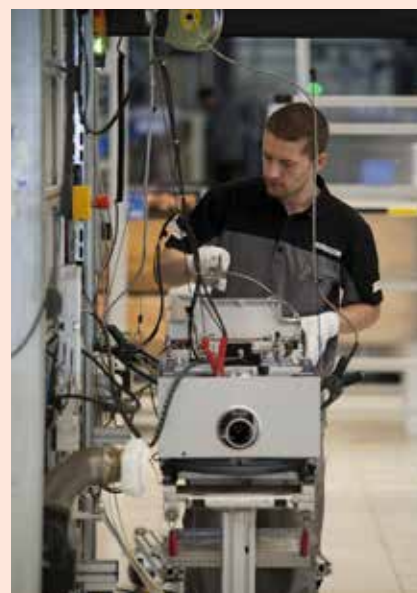
Montáž kotlov v závode Protherm Production
